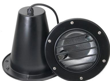
Fabricado em alumínio injetado para lâmpada VM de 70W ou 150W. Alojamento para reator separado. Pintura epóxi na cor branca ou preta. Modelo com grade. Lâmpada palito RX7s. Grau de proteção IP65. Fornecido com cabo PP (25cm).
