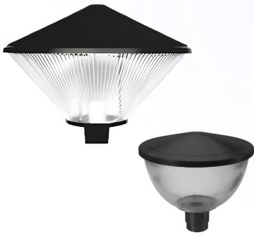
Luminária chapéu chinês para poste decorativo de 60,3mm. Tampa em alumínio repuxado e pintura epóxi, base em polímero com soquete E-40 ou E-27. Difusor em policarbonato prismático.
