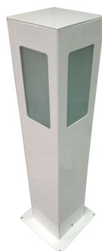
Balizador postinho **sobrepôr**, alumínio, pintura epóxi nas cores branca ou preta e vidro fosco. E-27 | IP54. Tubo 100x100mm.
