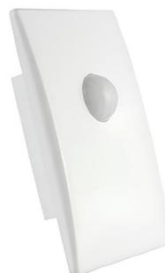
Sensor de presença embutir na parede. Bivolt automático. Carga: máximo 1200W. Grau de detecção: 120°. Faixa de detecção: máx. 9m. Config. tempo: 10seg - 15min. Ajuste de luz: 10~2000lm. IP20. Para caixa embutida 4x2.
