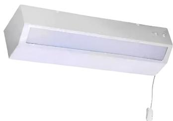
Arandela **interna** para leito hospitalar com botão. Chapa de aço tratada com pintura epóxi na cor branca. Difusor em poliestireno translúcido. Soquete G13 para lâmpada tubular led de 9W.
