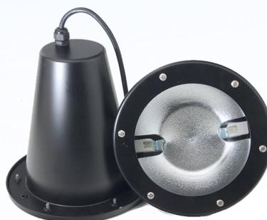
Fabricado em alumínio injetado para lâmpada VM de 70W ou 150W. Alojamento para reator separado. Pintura epóxi na cor branca ou preta. Lâmpada palito RX7s. Grau de proteção IP65. Fornecido com cabo PP (25cm).
