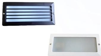
Balizador retangular para **embutir** em parede, alumínio injetado, difusor em vidro fosco, pintura epóxi nas cores branca ou preta. Soquete E-27 para lâmpada bulbo A60. IP54.
