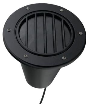
Fabricado em alumínio injetado para lâmpada PAR30 e PAR38 com foco fixo e AR111 com foco móvel. Pintura epóxi na cor branca ou preta. Grau de proteção IP65. Fornecido com cabo PP (25cm). Modelo com grade.
