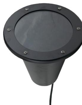
Fabricado em alumínio injetado para lâmpada PAR30 e PAR38 com foco fixo e AR111 com foco móvel. Pintura epóxi na cor branca ou preta. Grau de proteção IP65. Fornecido com cabo PP (25cm).
