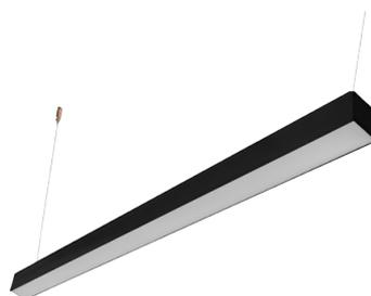
Pendente retangular 1 facho. Alumínio extrudado, pintura epóxi. Difusor em poliestireno translúcido. Placa led integrada.
