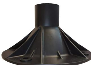
Flange em polipropileno reforçado para poste decorativo. Encaixe em tubo de 2" polegadas. Cores branca ou preta. 4 furos para uso de parafuso 3/8.
