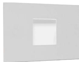
Balizador para **embutir** em parede, alumínio injetado, vidro fosco, pintura epóxi nas cores branca ou preta. Soquete G9 para lâmpada bipino led. IP20. Fixação em caixa 4x2.
