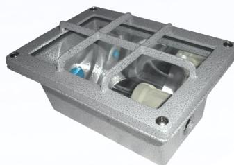
Balizador retangular para **embutir** em parede, alumínio injetado, difusor em vidro transparente com refletor em alumínio, pintura epóxi nas cores cinza martelado, branca ou preta. Soquete E-27 para lâmpada bulbo A60. IP54.
