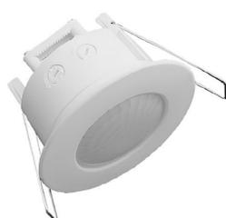
Sensor de presença embutir no teto. Bivolt automático. Carga: máximo 1200W. Grau de detecção: 360°. Faixa de detecção: máx. 6m. Config. tempo: 10seg - 7min. Ajuste de luz: 10~2000lm. IP20.
